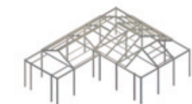
■鉄骨構造 住宅内部から鉄骨を組上げる。施工を考えて鉄骨の重量・長さに配慮
