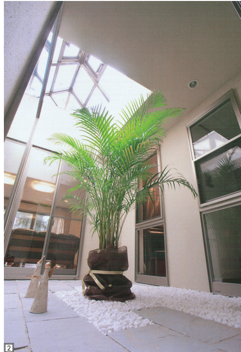
2 「湘南」をイメージしてデザインしたライトコート。風を通すため、四方方向の開口部が開けられる設計。トップライトも開閉。
