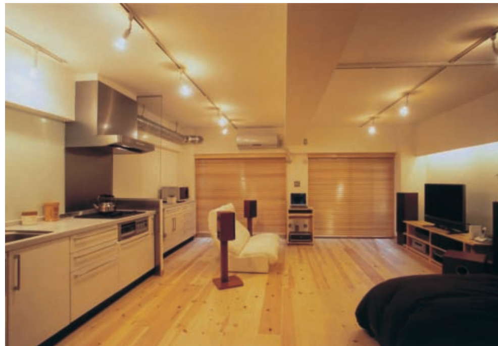
④天井を高く取って広がりを出したワンルームのLDK。露出の梁やダクトもデザインの要素とし、間接照明で存在感をカバーした。
